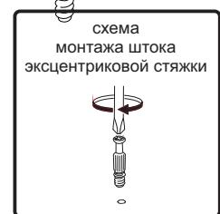
17. Соедините эксцентриковыми стяжками крышку №22 с боковинами №25, верхним фасадом №21.
