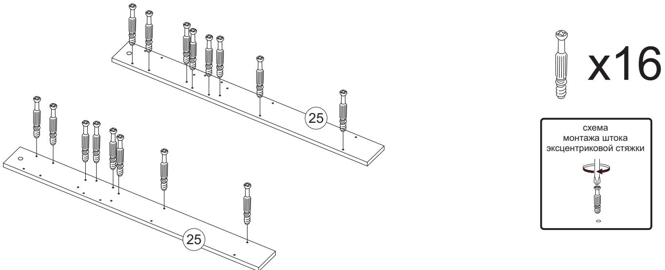
12. Соедините эксцентриковыми стяжками боковину №25 с щитом фасадом №20, средним фасадом №24, верхним фасадом №21. \*В средний фасад №24 ставьте эксцентрики (бочонки) с обеих сторон.
