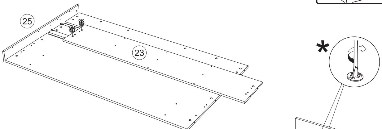
14. Соедините эксцентриковыми стяжками вторую боковину №25 с щитом фасадом №20, фасадом средним №24, фасадом верхним №21, задней стенкой №23.
