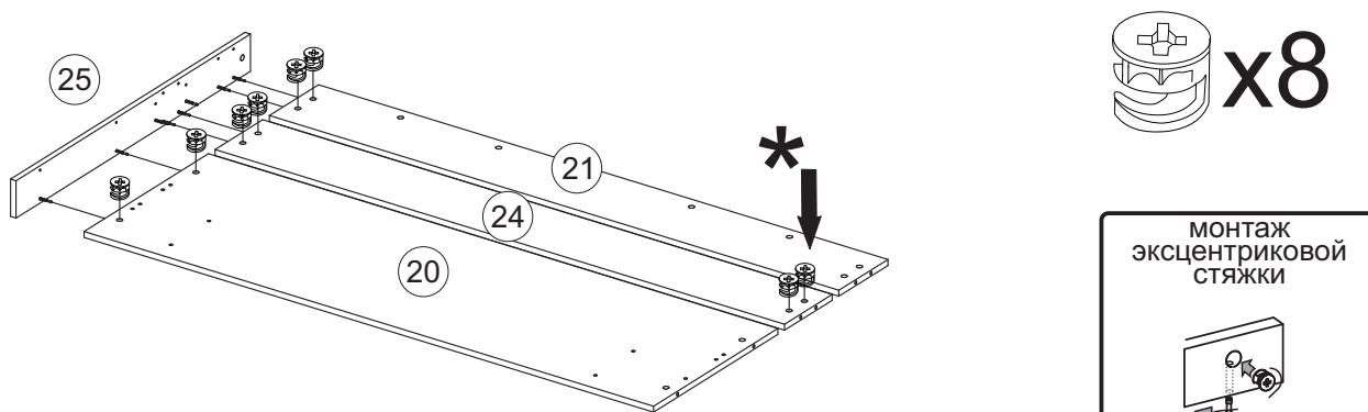
13. Соедините эксцентриковыми стяжками боковину №25 с задней стенкой №23.
