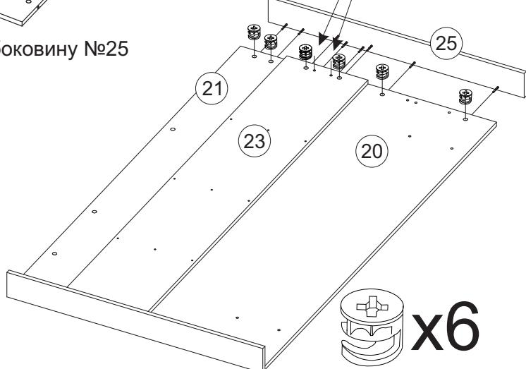
15. Соедините шурупами 4x30 заднюю стенку №23 с щитом фасадом №20, средним фасадом №24, верхним фасадом №21.
