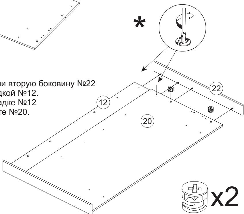
14. Соедините шурупами 4x30 головной щит №20 и фасад накладку №12.
