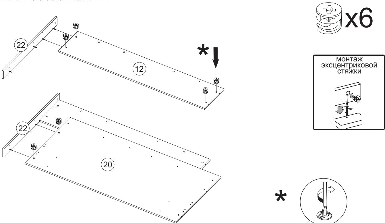
13. Соедините эксцентриковыми стяжками вторую боковину №22 с головным щитом №20, фасадом накладкой №12.
