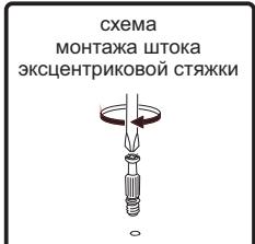
**9.** Соедините эксцентриковыми стяжками царгу №1, №2 с передней перегородкой №4 и средней перегородкой №5.
