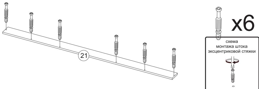
16. Соедините эксцентриковыми стяжками крышку №21 с боковинами №22, фасадом накладкой №12.
