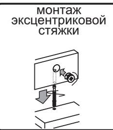
11. Подготовьте боковины №22 к дальнейшему монтажу. Для этого вкрутите в них штоки эксцентриковых стяжек так, чтобы на одной боковине они были вкручены слева, а на другой справа.
