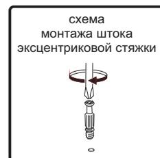
18. Соедините эксцентриковыми стяжками крышку №22 с боковинами №25, фасадом верхним №21.
