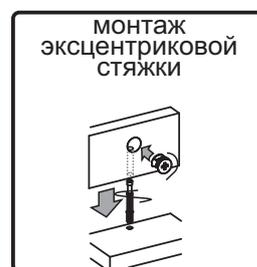
11. Подготовьте боковины №25 к дальнейшему монтажу. Для этого вкрутите в них штоки эксцентриковых стяжек так, чтобы на одной боковине они были вкручены слева, а на другой справа.
